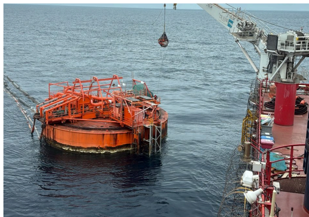
Bouée CALM en mer, avec le navire de soutien à couple.
